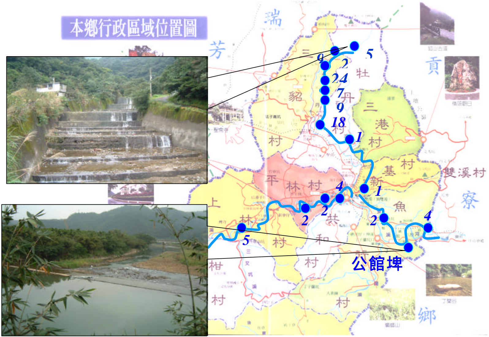
圖 8 雙溪流域治理概況(固床工與攔砂壩分布位置)
